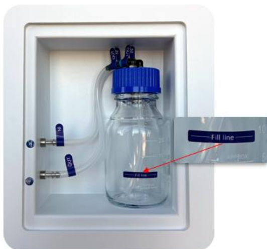
Kuva 21.1 Kosteutuspullon ja monivyöhykkeisen ART -työaseman putkiliitäntä
